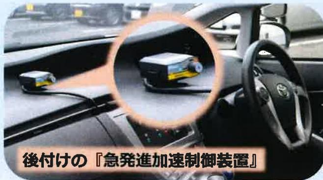
後付けの『急発進加速制御装置』
