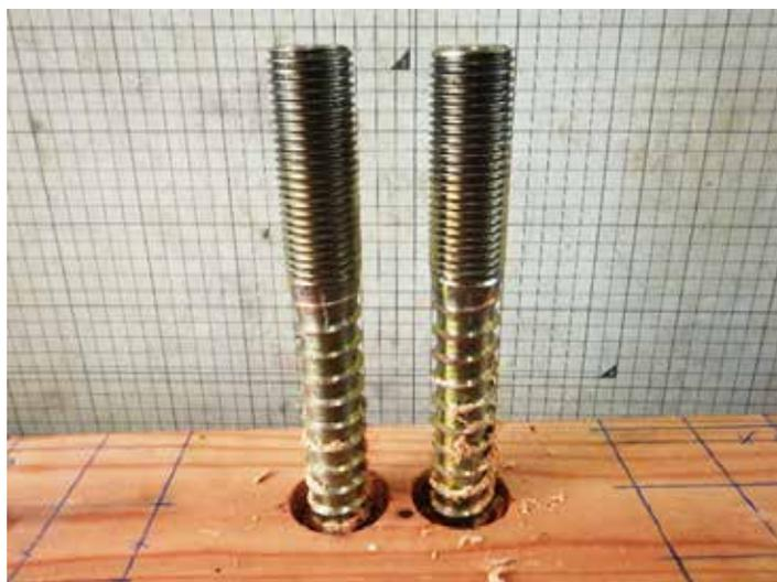
写真 2 LSB 引き抜けによる周辺部材の破壊
