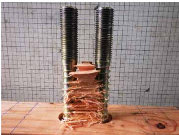
写真 1 LSB 引き抜けによる周辺部材の破壊・ LSB 間部材引き抜け
