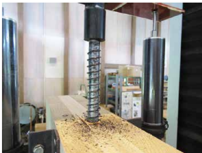
写真 1 接合具周辺木部の破壊・LSB の伸び
