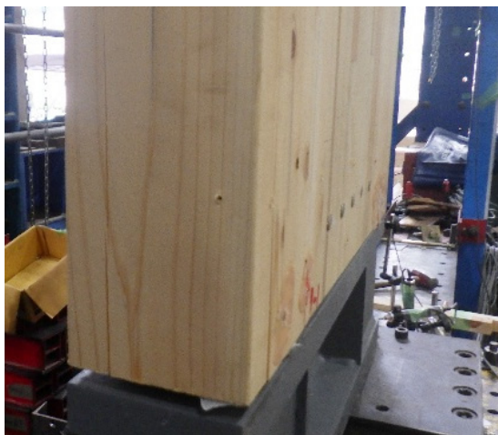
木材の割裂破壊
