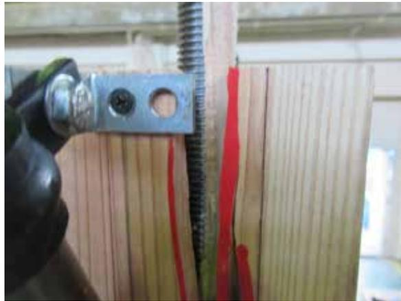
写真 1 GIR 引き抜けによる周辺部材の破壊
