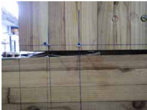
タフネスコネクターの破断
