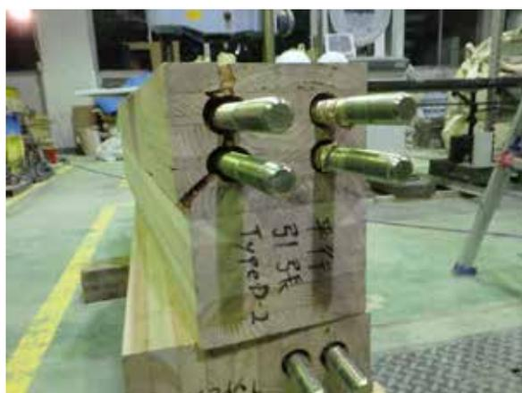
写真 2 LSB 引き抜けによる周辺部材の破壊・ LSB 埋め込み付近の部材割裂破壊
