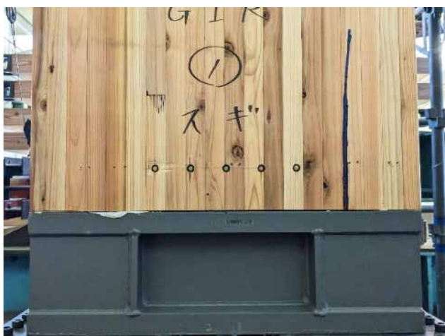
木材の割裂破壊
