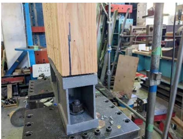
木材の割裂破壊
