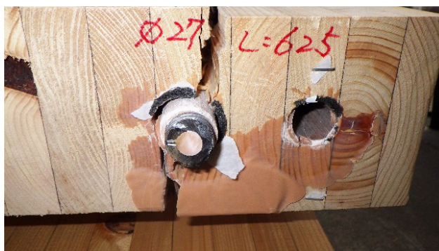
コネクタ位置割裂破壊
