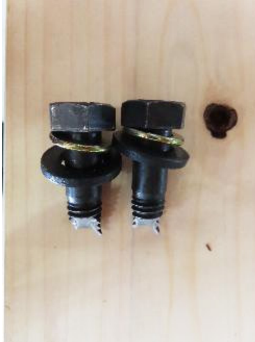
写真 1 引張側ハイテンションボルトの破断
