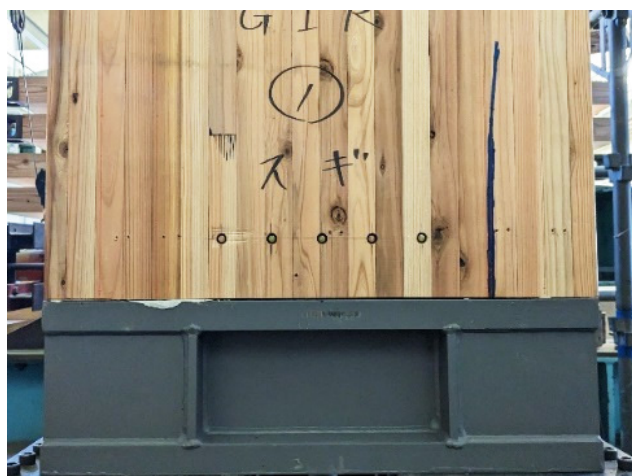
木材の割裂破壊
