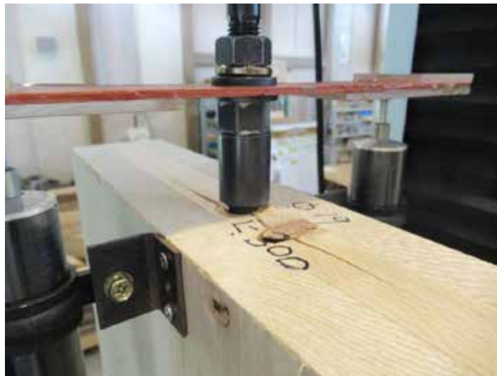
写真 1 接合具周辺木部の破壊
