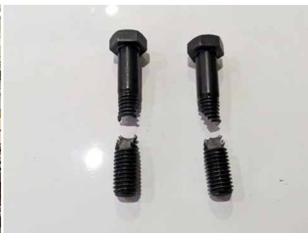
ハイテンションボルトの破断
