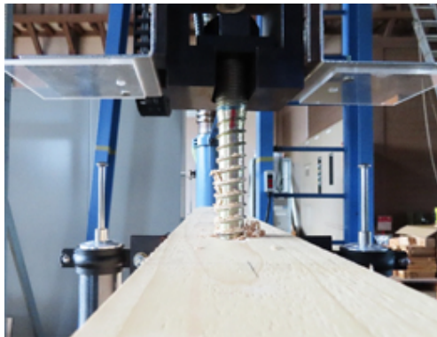
写真 1 LSB 引き抜けによる周辺部材の破壊
