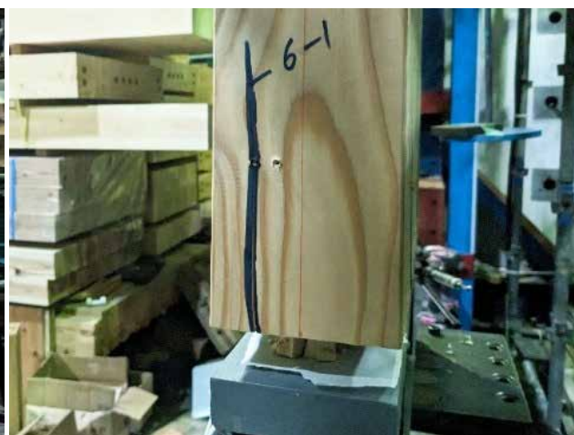
木材の割裂破壊
