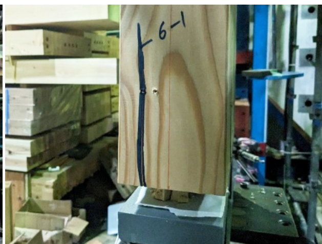
木材の割裂破壊
