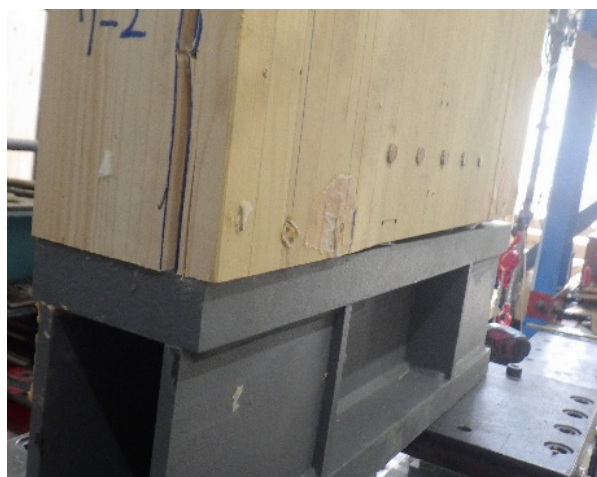
木材の割裂破壊
