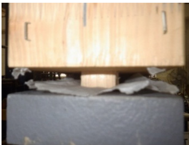
GIR 引き抜け
