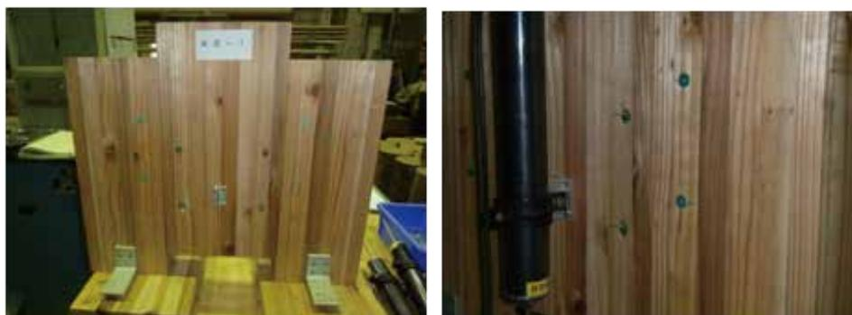
・主材又は側材のビスが折れて耐力低下し、後は変形が進む。
