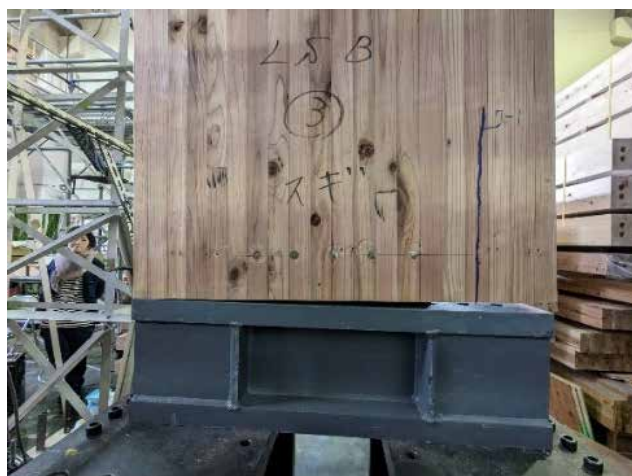
木材の割裂破壊
