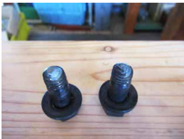
写真 3 引張側ハイテンションボルトの破断 （S2-750-01）（3 体とも同じ破壊性状）
