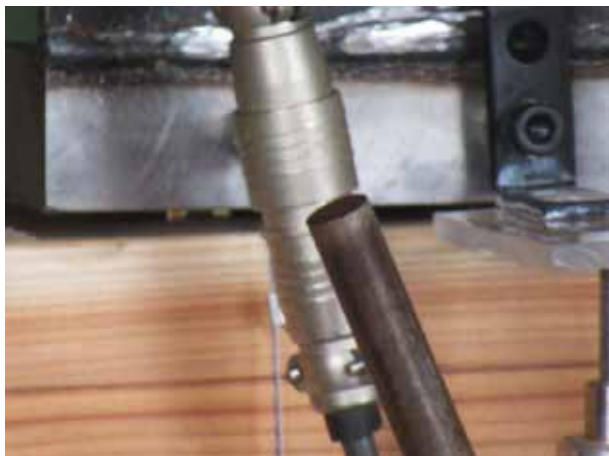
写真 1 LSB の引き抜け（S2-750-03） （3 体とも同じ破壊性状）
