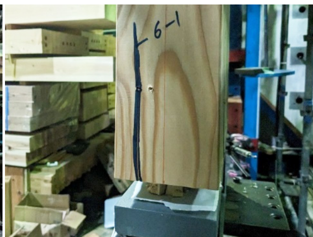
木材の割裂破壊
