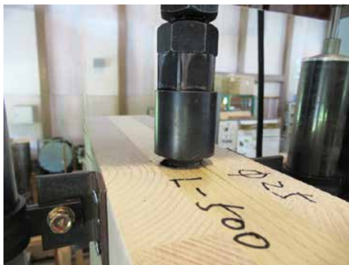
写真 1 LSB 引き抜け・木材割裂破壊
