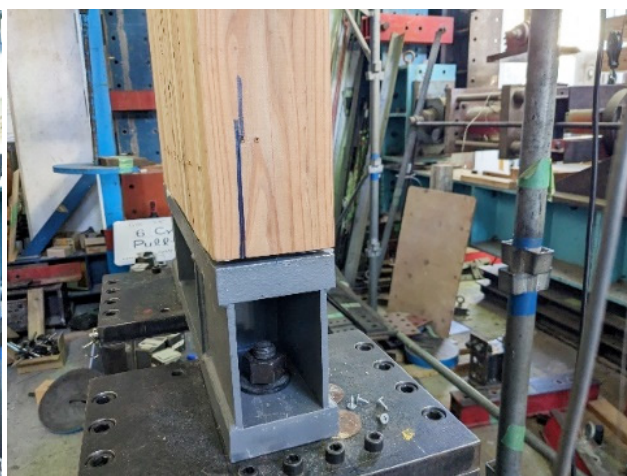
木材の割裂破壊
