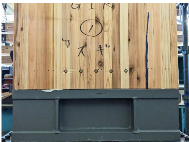
木材の割裂破壊
