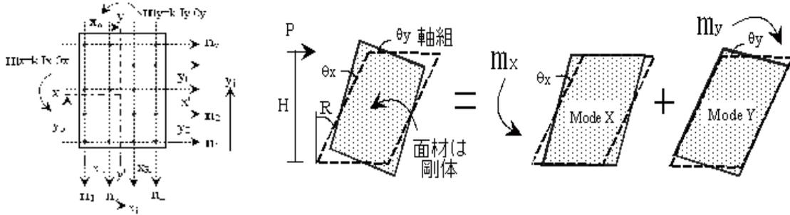
図 面材張り耐力壁のモデル化の例
