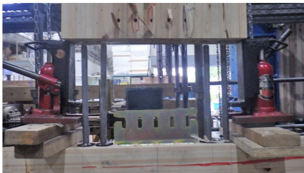
タフネスコネクタの破断
