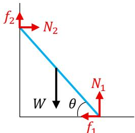
床との接点のまわりの力のモーメントのつり合い、 $W \times \frac{l}{2} \cos \theta = N_2 \times l \sin \theta + f_2 \times l \cos \theta \dots ③$  の
