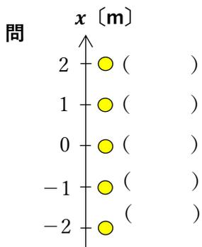
図の物体にはたらく力が  $F = -10x$  [N] のとき、( ) 内に力の値を記せ。また、図中に力を矢印で描け。
