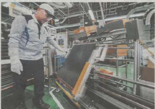
ダイキン工業滋賀製作所の組み立てラインには、大型部品を載せると、その自重で次工程に運ばれていくレール付きの作業台を導入した(滋賀県草津市)
