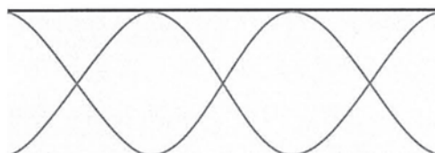
管の長さの \frac{2}{3} 倍の波長の音（第3倍音）
