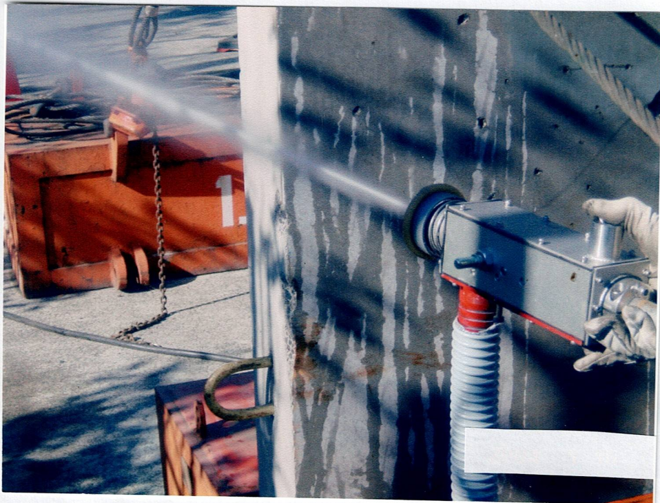
写真②-③ ズルヘッドの遮蔽版にリンクの押しボタンを強制的に押し WJの噴射状況をテスト中。
