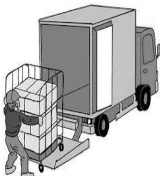
貨物自動車での荷役作業に関し、墜落・転落、荷の崩壊・倒壊等の労働災害が多発し、このような状況から労働安全衛生規則が改正され、昇降設備の設置義務や保護帽の着用範囲が拡大されました。
