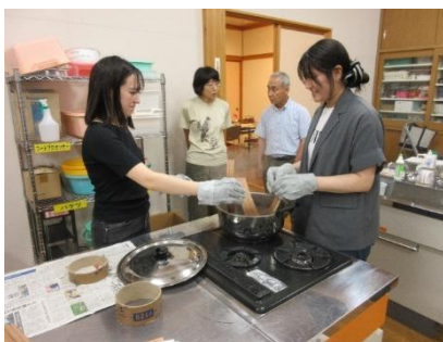
杉と檜の 3mm 薄板を茹でて曲げて、地元で途絶えた大平メンツ（曲げわっぱ）づくり
