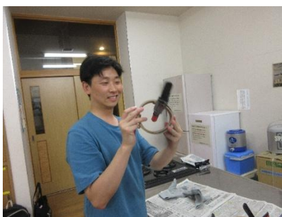
杉と檜の 3mm 薄板を茹でて曲げて、地元で途絶えた大平メンツ（曲げわっぱ）づくり
