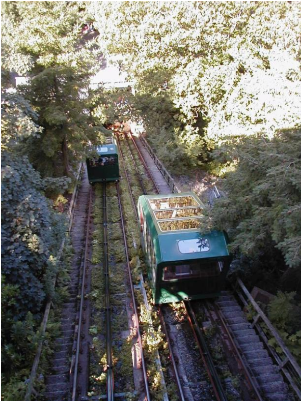
写真 英国C. A. T. の水の重力活用による無電化ケーブルカー。
