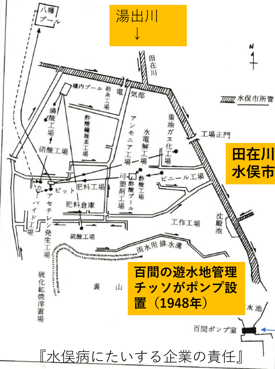
④ 新日窒水俣工場並その周辺の排水溝並排水処理施設綜合計画概要図
