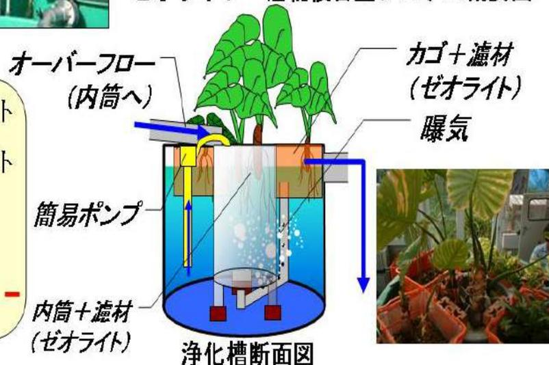
別棟として植物と微生物を活用した汚水浄化実験プラントを設置し、ミニ生態系による汚水浄化プラントの開発的実験を行う。この種の施設の試験は我が国では先駆的な実験施設である。植物だけでなく、ゼオライト等のミネラル材の活用も図る。将来は、施設内汚水浄化施設としても活用できる可能性を探る。
