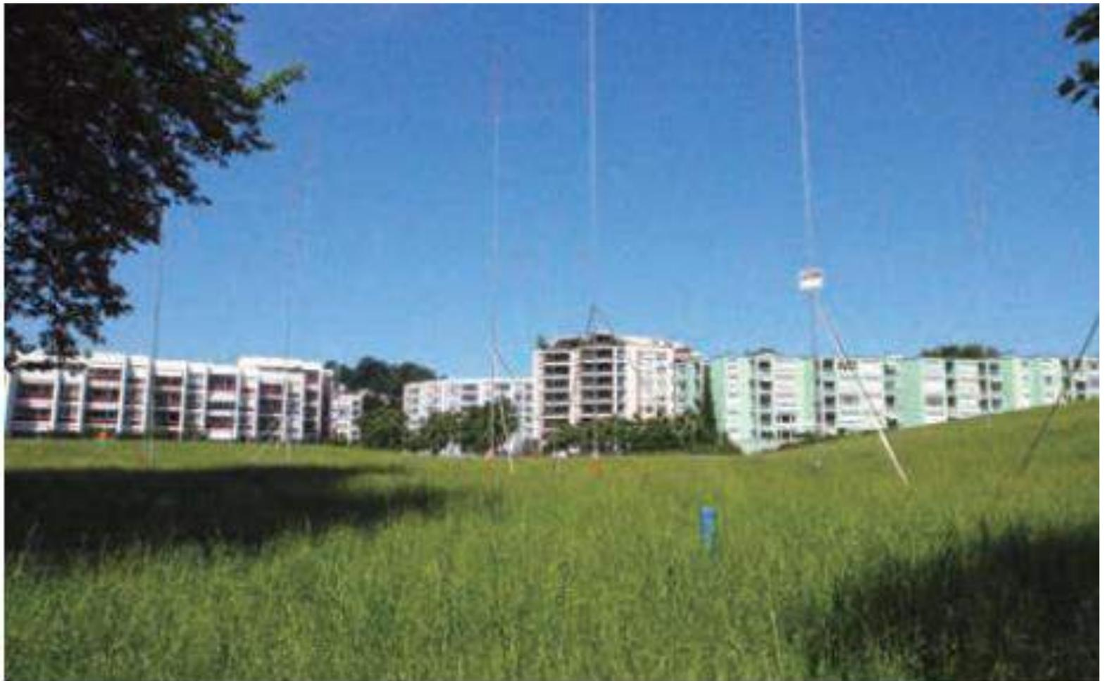
写真4 建設現場での計画輪郭表示が閲覧・審査期間に義務づけられ、建物の建つ現場での高さや環境について市民が直接感じ異議申し立てできる。ポールが設置され、建物の高さが示されている (Wikipedia commonsより)
