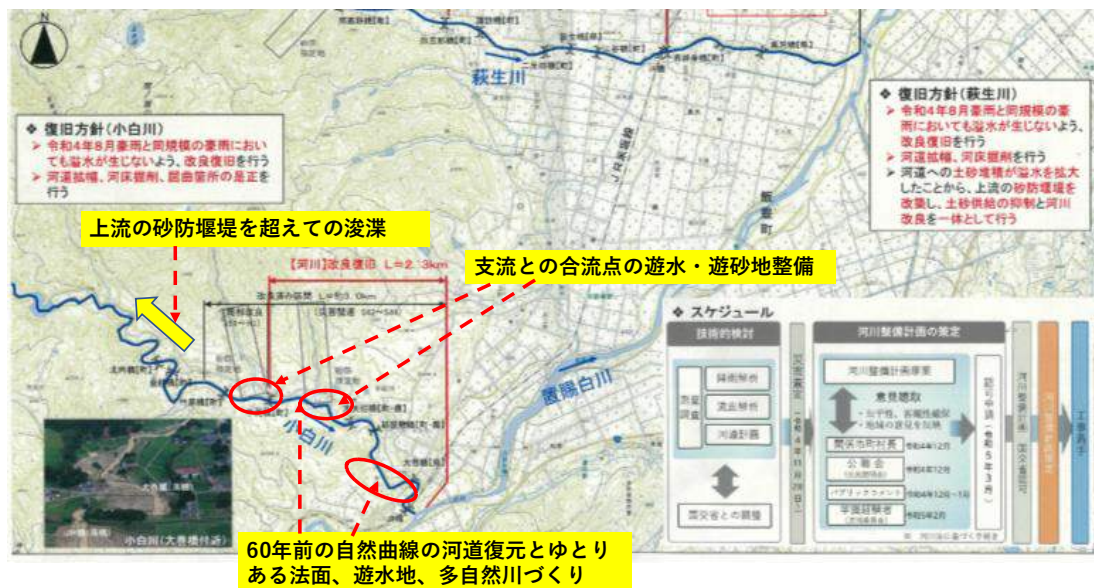
図 45 山形県の小白川の改良復旧計画案（黄色地は糸長の追記）
