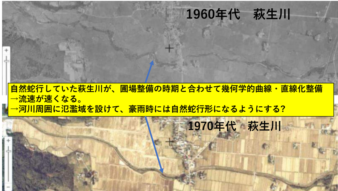
図 18 萩生川の河道整備前後での航空写真比較（国土地理院 WEB 地図を加工）
