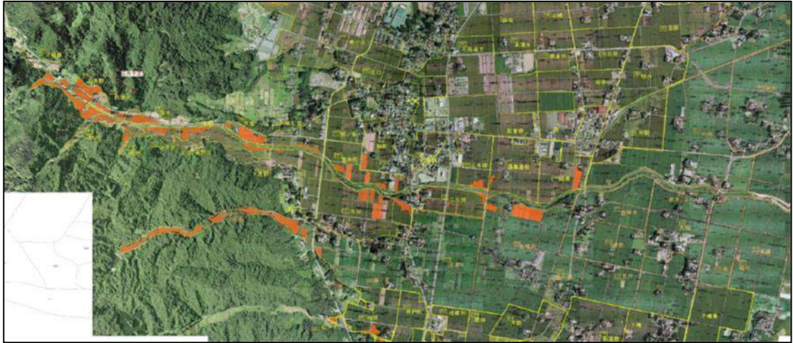
図 5 萩生川沿いの農地被害（役場資料より）
