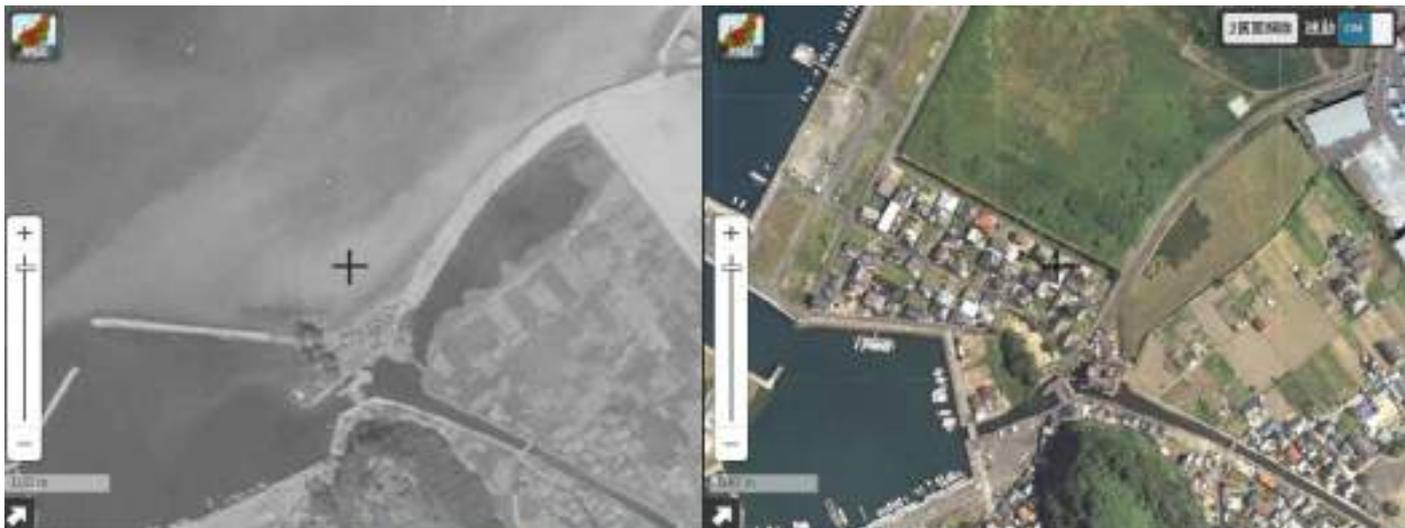
写真上左は、1960年代の丸島港、樋門、大廻りの塘、遊水地、海岸線の状況がよくわかる。樋門手前右側の遊水地の規模が大きく、丸島排水路の排水を貯める機能を果たす。その後、チッソが大廻りの塘の浜を埋め立て、住宅地及び工場廃棄物で埋め立て、現在はソーラーパネルの設置場所。
